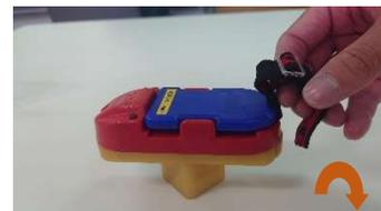
カードの裏面（ラベル側）を下側にして、②の部分ユニットの①の部分に斜めに押し当て、②を支点に③を下方向に押し下げます。
