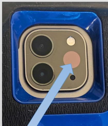
LiDARレンズ（レーザー距離計）
