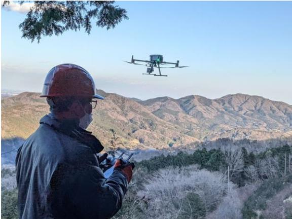
LiDAR搭載ドローンを飛ばし、距離や位置形状を3次元で測定します。
